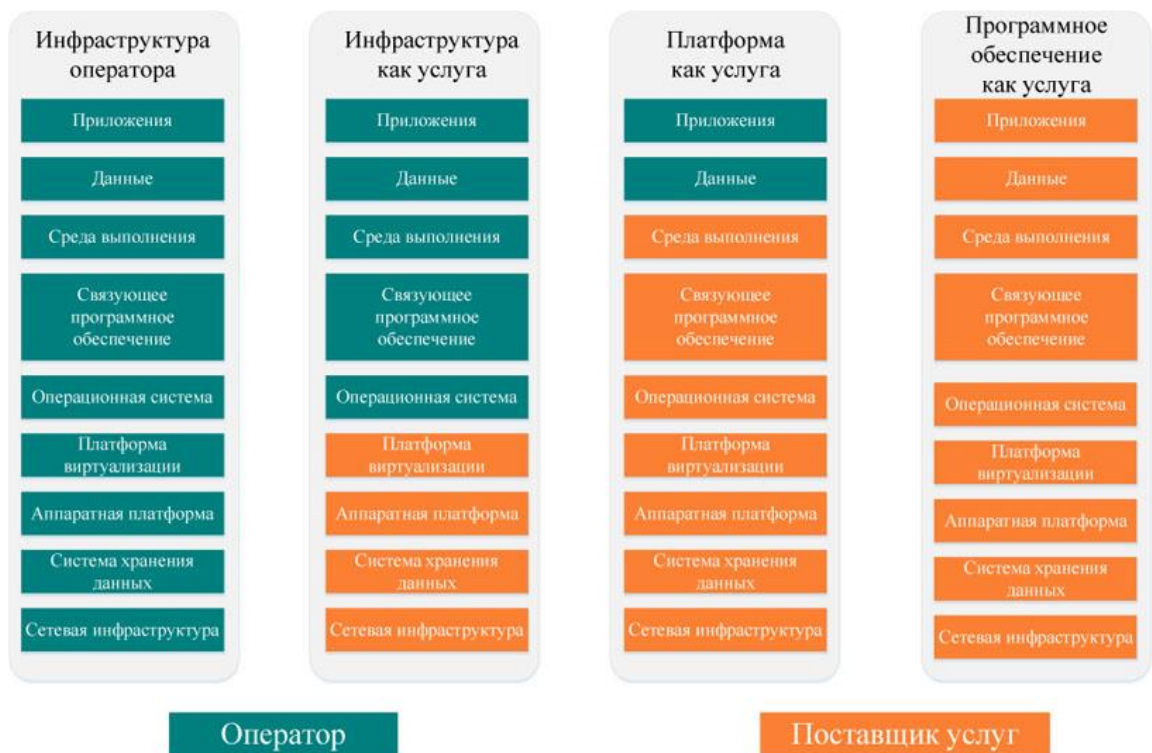
Рисунок 4. Пример распределения границ при оценке угроз безопасности информации в информационной инфраструктуре поставщика услуг
